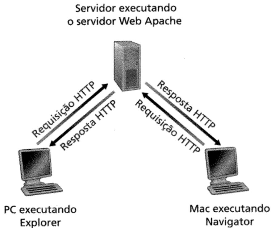
Figura 01 – Comunicação Cliente servidor. Fonte: KUROSE, 2006.
